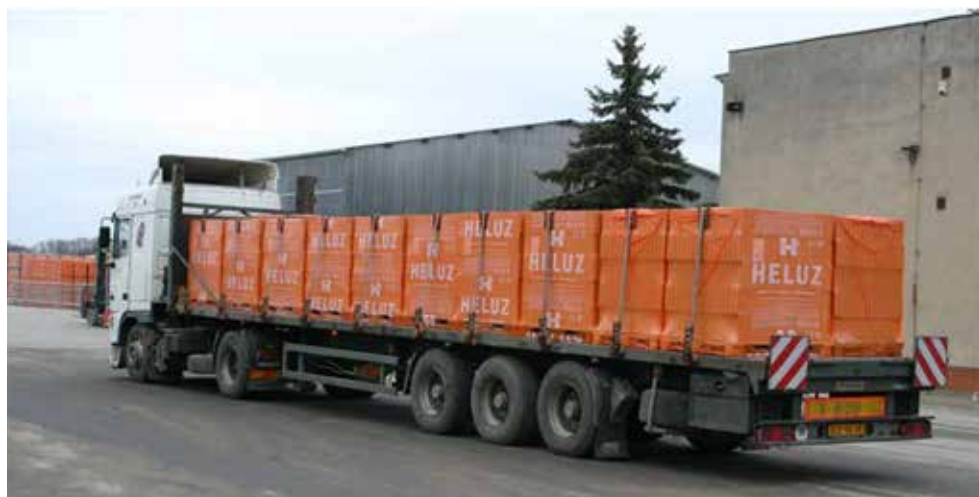
Obr. Pohled na řádně naložené palety s cihlami na nákladním automobilu
