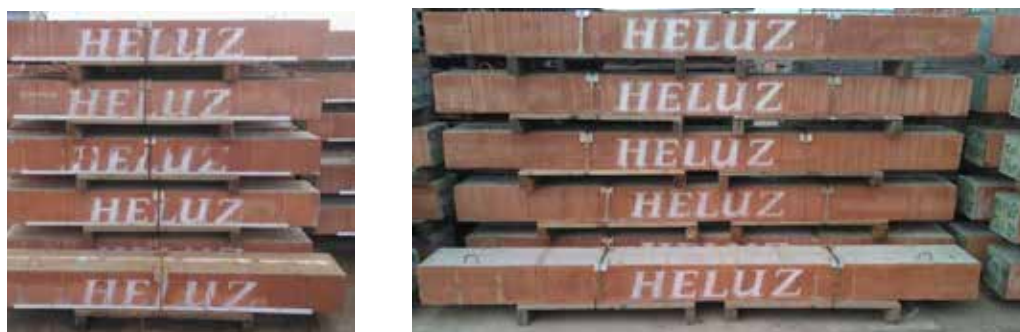
Obr. 7 Roletové překlady na skládce, vlevo do délky 250 cm (jedna paleta), vpravo od délky 275 cm
