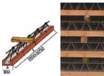
Obr. 8 Správná poloha umístění prokladů Obr. 7 Ukázka slohy stropních nosníků
