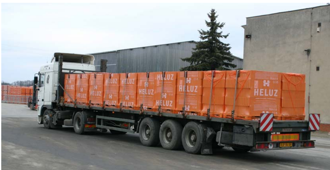
Obr. Pohled na řádně naložené palety s cihlami na nákladním automobilu
