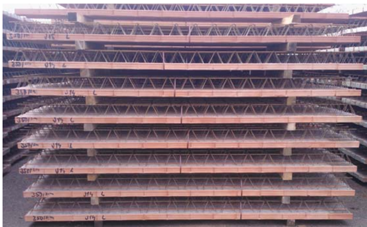
Obr. 6 Správná poloha umístění prokladů Obr. 7 Ukázka slohy stropních nosníků
